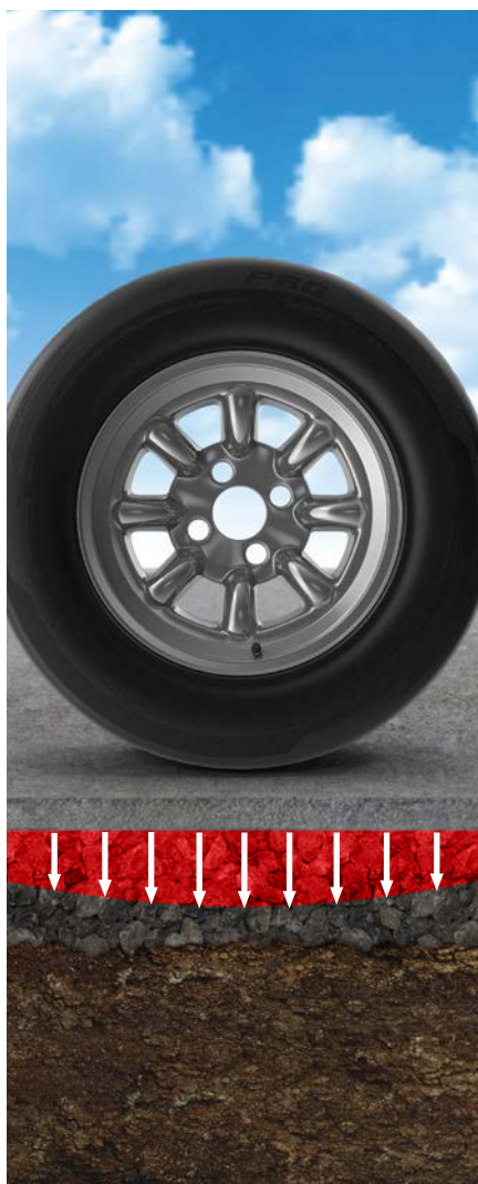
Nejlepší varianta rozložení napětí v betonové vozovce
